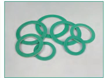
Für flachdichtende Verschraubungen (Nr. 330/331/95/97), ausgenommen Art.-Nr. 49011, 49012 und 49013. Synthetische Fasern, gebunden mit NBR. Geeignet für Öle, Wasser, Dampf, Gase, Salzlösungen, Kraftstoffe, Alkohole, schwache organische und anorganische Säuren, Kohlenwasserstoffe, Schmierstoffe und Kältemittel. DIN-DVGW/SVGW-Zulassung. BAM-, HTB- und KTW- geprüft.
