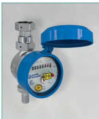
Zapfhahnzähler mit Schutzhaube aus Kunststoff, für den Anschluss an ein Auslaufventil inkl. Anschlusskupplung mit Plombierbohrungen, Schlauchverschraubung, Qn 1,5 BL 80 mm, Temperaturbereich bis 30°C, Rollenzählwerk drehbar, geeicht
