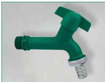
Ventilkörper/Griff aus PA6, RoHs- (Kat.2) / REACH-konform, O-Ringe aus EPDM mit KTW/W270 Zulassung, Oberteil Messing gemäß DIN 50930-6, Überwurfmutter aus Messing, Tülle aus Edelstahl
