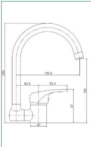
Für die Unterfenstermontage, abklappbarer Auslauf, schwenkbar, flexible Anschluss-Schläuche 50 cm, geräuscharme Kartusche Ø 40 mm
