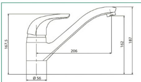
Mit schwenkbarem Gussauslauf 200 mm Ausladung, flexible Anschluss-Schläuche 50 cm, geräuscharme Kartusche Ø 40 mm
