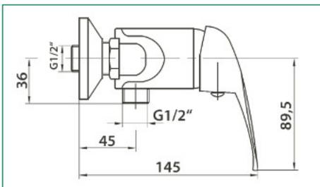
Mit schallgedämpften S-Anschlüssen und verchromten Rosetten, 40 mm Kartusche, Brauseanschluss 1/2"
