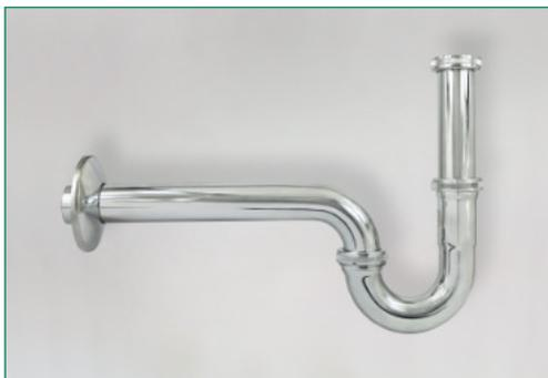
Edelstahl-Röhrengeruchverschluss, verchromt, Rosette Ø 80 mm, Verstellrohr 120 mm, Abgangsbogen 250 mm
