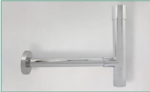
Massiv MS-Flaschengeruchverschluss, verchromt, mit Rosette, gegossene Tasse, Verstellrohr 165 mm, Abgangsrohr 300 mm, mit Tauchrohrabdeckung
