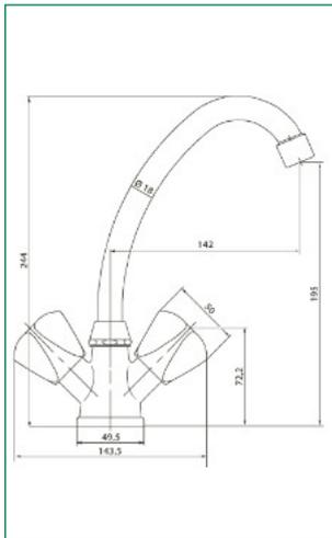
Hauben-Griff Kunststoff mit Kupfer-Rohr-Auslauf 130 mm, Kettenöse, flexible Anschluss-Schläuche 2 x 50 cm, 1 x 35 cm, Geräuschklasse geprüft
