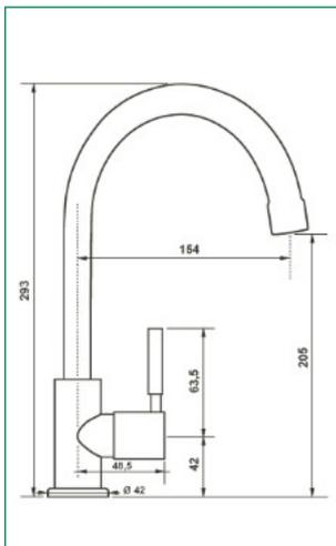
Standschwenkventil, Edelstahl, Rohrauslauf 1/2" x 160 mm
