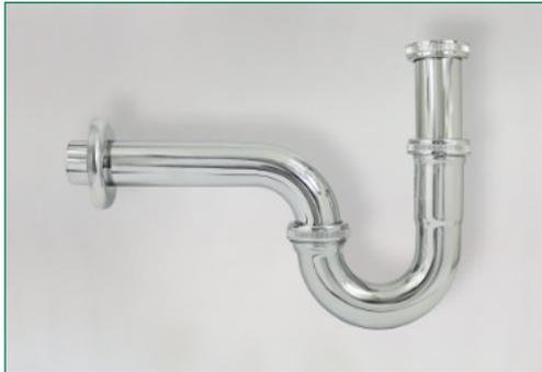
Edelstahl-Röhrengeruchverschluss, verchromt, Rosette Ø 65 mm, Verstellrohr 75 mm, Abgangsbogen 170 mm
