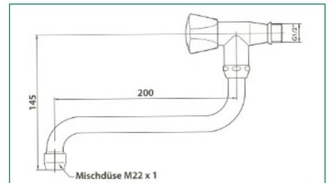
Hauben-Griff Zamak mit S-Auslauf (200 mm), schwenkbar, mit S-Anschlüssen und verchromten Rosetten
