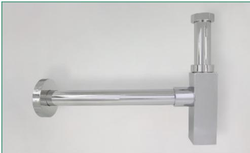
Massiv MS-Flaschengeruchverschluss, verchromt, mit Rosette, gegossene Tasse, Verstellrohr 200 mm, Abgangsrohr 300 mm
