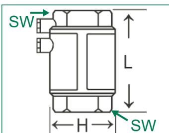
Avec purgeur double, version lourde, clapets de non-retour en acier, 2 vis latérales à purgeur, ainsi particulièrement convenablement dans la construction de fontaine, en hiver aucun démontage ou danger de gelée dans les installations de fontaine
