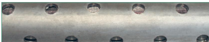
**Indication:** Le trou de fontaine devait être percé absolument\* à l'avance avant de faire rentrer le filtre et les tubes de pompes (cf. l'instruction ouvrière est la page 62), pour éviter des dommages au filtre/tube. Le filtre doit être rincé librement après la rentrée.
