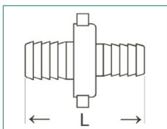
À joint plat, joint NBR inclus, en laiton matricé
