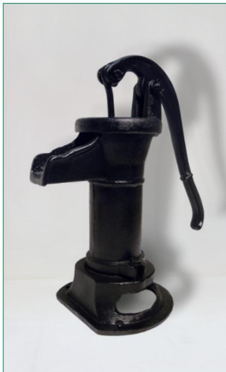
En fonte, noire, hauteur d'aspiration 7 meter colonne d'eau, raccordement 1 1/4", piston 75 mm
