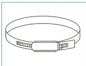
Bande et boîtier en acier inoxydable ou en acier zingué bichromaté selon la norme DIN 3017, vis en acier zingué, largeur de bande 9 mm
