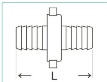
À joint plat, inclus joint NBR, laiton matricé
