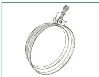
2 pièces, bande perforée en acier inoxydable 1.4104, boîtier et vis en acier zingué, largeur de bande 9 mm
