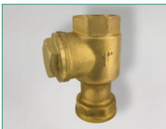
Laiton, au choix, forme de passage ou d'angle en vissant le couvercle de fermeture capuchon, PN 10, filetage intérieur des deux côtés, cône de fermeture avec joint en caoutchouc, convient uniquement pour un montage vertical
