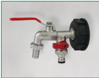
S 60 x 6 Grobgewinde (IG) und IG (Anschlussgewinde), mit O-Ring, HDPE-Kunststoff schwarz, mit Doppel-Kugelauslaufventil, matt verchromt, Schlauchtülle, roter Stahlhebel, Miniventil mit Steckanschluss, Verwendung nur für Brauch-/Nutzwasser
