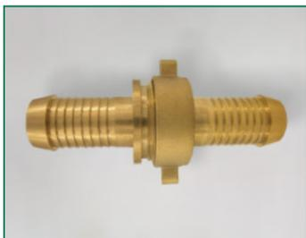
3-teilig, MS warmgepresst, schwere Ausführung, flach dichtend inkl. Dichtung aus NBR, verlängerte Schlauchtülle mit erhöhter Endrippe für besseren Schlauchsitz
