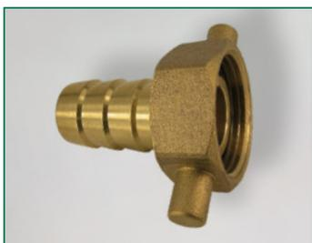
2-teilige Schlauchverschraubung mit Sechskant-Nockenmutter, MS-blank, warmgepresst, schwere Ausführung, flach dichtend, verlängerte Schlauchtülle mit erhöhter End-rippe für besseren Schlauchsitz
