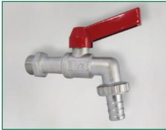
Mit Zentrierstern und Blech-Schlauchverschraubung, Aluminiumhebel mit Fixierung (ummontierbar, feststellbar), wahlweise rot oder blau, MS 58 warmgepresst, vernickelt
