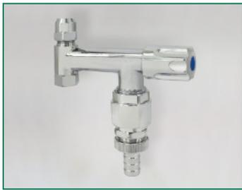
Waschgeräte-Doppeleckventil, zum nachträglichen Einbau eines Gerätes an ein bereits montiertes Eckventil, Pressmessing, poliert-verchromt, mit Rückflussverhinderer, Rohrbelüfter und Schlauchverschraubung, zugfeste Messing-Konus-Quetschverschraubung 3/8" (Ø 10 mm) mit Längenausgleich, verpackt im Einzelkarton
