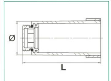
Komplett aus Kunststoff, gemäß DIN 1988-2, nur zur einmaligen Dichtigkeitsprüfung, nicht zur dauerhaften Abdichtung geeignet
