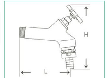
Ventilkörper/Griff aus PA6, RoHS- (Kat.2) / REACH-konform, O-Ringe aus EPDM mit KTW/W270 Zulassung, Oberteil Messing gemäß DIN 50930-6, Überwurfmutter aus Messing, Tülle aus Edelstahl
