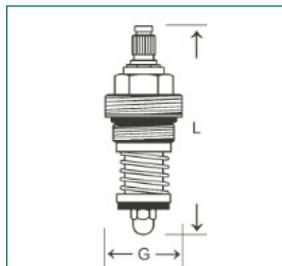
Aus Pressmessing, mit Rückflussverhinderer, für Geräteanschlussventile
