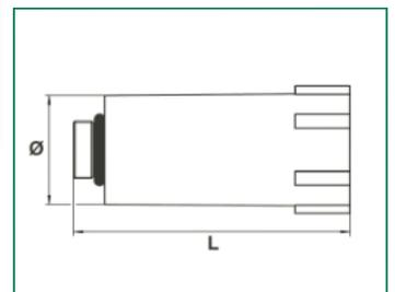
Komplett aus Kunststoff mit 3 x Außengewinde (G 3/8", G 1/2", G 3/4"), nicht zur dauerhaften Abdichtung geeignet
