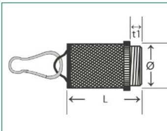
Aus feinmaschigem Edelstahl mit Kunststoffanschlussgewinde, mit Öse und Karabiner
