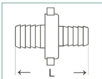
Flachdichtend, inkl. Dichtung aus NBR, warmgepresst
