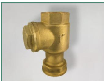
Messing, wahlweise Durchgangs- oder Eckform durch Umschrauben der Verschlusskappe, PN 10, beidseitig Innengewinde, Schließkegel mit Gummidichtung, nur für senkrechten Einbau geeignet
