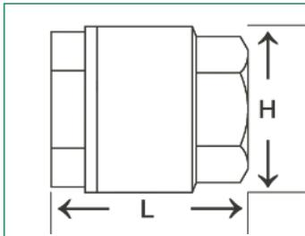
Lange Form, mit Feder, Ventilkegel aus Messing mit Gummidichtung, auch zur Horizontalmontage geeignet
