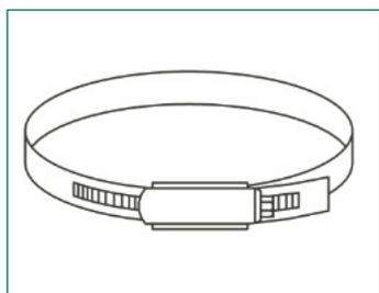
Band, Gehäuse und Schraube aus Edelstahl oder gleichwertigem korrosionsbeständigem Stahl gemäß DIN 3017, Bandbreite 9 mm
