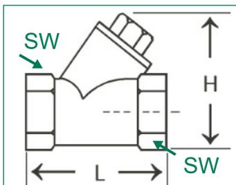
Messing-Sandfilter mit feinmaschigem Sieb aus Edelstahl 1.4301, beidseitig Innengewinde
