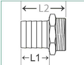
Messing, warmgepresst, blank, für Schelleneinbindung, AG
