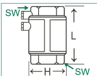
Mit doppelter Entlüftung, schwere Ausführung, Edelstahlrückschlagklappe, 2 seitliche Entlüftungsschrauben, dadurch besonders geeignet im Brunnenbau, im Winter keine Demontage oder Frostgefahr in der Brunnenanlage
