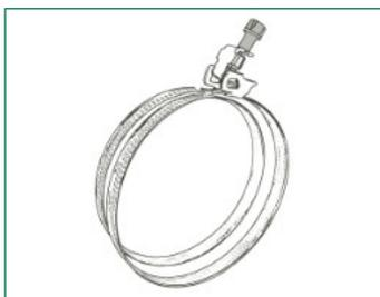
2-teilig, Band Edelstahl 1.4104, Gehäuse und Schraube Stahl verzinkt, 9 mm Bandbreite, Spannbreite 50-165 mm
