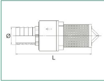
Feinmaschiger Edelstahl-Vorsatzfilter mit Kunststoffanschlussgewinde, mit Öse und Karabiner (für 51363) und Schlauchtülle aus Messing
