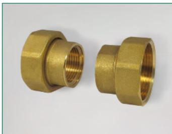
Pumpenverschraubungs-Set, Messing blank, bestehend aus: 2 Überwurfmutter, 2 Einlegeteilen und 2 Flach-Dichtungen, PN 10, Temperaturbereich: - 10°C bis + 110°C
