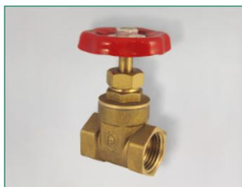
Druckstufe PN 10, rot emailliertes Handrad, Dichtungen aus PTFE, Stopfbuchse, IG/IG, warmgepresst bis 2" einschließlich
