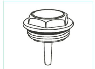
Messing blank, Muffen-Rückschlagklappe, mit Verschlusskappe, Klappe nicht federbelastet, IG/IG, metallisch dichtend, nur für senkrechten Einbau geeignet
