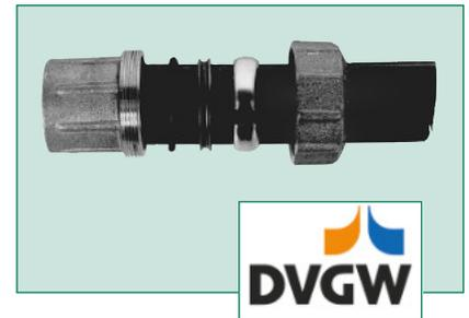
Bestehend aus Gehäuse, z. B. Innengewinde, O-Ring, Druckring, Spannring und Verschraubung (Überwurfmutter). Bei Medium Gas muss zusätzlich eine Gashülse bzw. ein Stützröhrchen eingesetzt werden.
