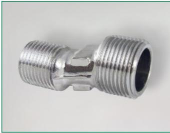
S-Anschlussnippel, MS-vernickelt, Ausladung 12,5 mm, 3/4" AG x 1/2" AG, SW 16
