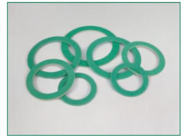
Für flachdichtende Verschraubungen (Nr. 330/331/95/97), ausgenommen Art.-Nr. 49011, 49012 und 49013. Synthetische Fasern, gebunden mit NBR. Geeignet für Öle, Wasser, Dampf, Gase, Salzlösungen, Kraftstoffe, Alkohole, schwache organische und anorganische Säuren, Kohlenwasserstoffe, Schmierstoffe und Kältemittel.
