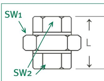
IG x IG, flachdichtend, ohne Dichtung, Ausführung -D inkl. Dichtung 4900X
