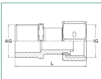
Messing warmgepresst, blank, Überwurfmutter mit Plombierbohrung, Anschlussstutzen mit Außengewinde, **mit Dichtung**
