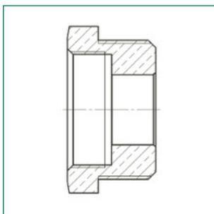
MS-Reduzierstück mit AG/IG für flachdichtende Verschraubungen
