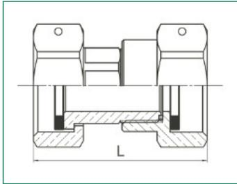
Messing verchromt, beidseitig Innengewinde, für Anschluss an Auslaufventile 1/2" und 3/4", Überwurfmutter mit Plombierbohrungen
