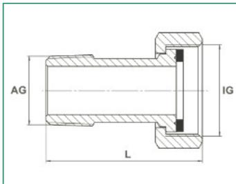
Messing warmgepresst, blank oder verchromt, Überwurfmutter mit Plombierbohrung, Anschlussstutzen mit Außengewinde, **mit Dichtung**
