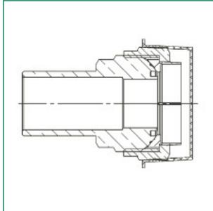
Stutzen, metallisch dichtend, Klemmschalen mit Verzahnung, mit roter Kunststoff-Schutzkappe
