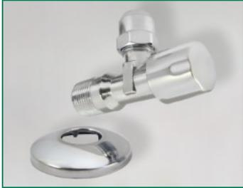
Aus Pressmessing, poliert-verchromt, mit Längenausgleich und Schubrosette, zugfeste Messing-Konus-Quetschverschraubung 3/8" (Ø 10 mm) mit Längenausgleich, Prüfzeichen PA-IX692/IA; Geräuschklasse I, Verpackung im Einzelkarton\*
