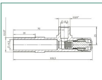
Blank oder vernickelt, mit oder ohne Rosette, mit oder ohne Quetschverschraubung, 1/2", DVGW- u. SVGW-Zulassung
