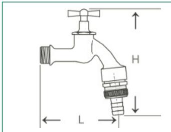
Mit Knebeloberteil und Schlauchverschraubung wahlweise aus Kunststoff oder Blech. Mit Rohrbelüfter nach DIN DVGW (Größe 1/2") und Rückflussverhinderer
