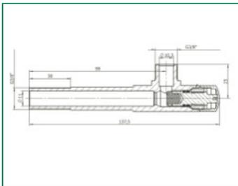
Blank oder vernickelt, mit oder ohne Rosette, mit oder ohne Quetschverschraubung, 3/8", DVGW-Zulassung
