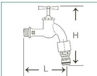
Wie 52061, jedoch mit Rohrbelüfter nach DIN DVGW (1/2") und Schlauchanschlusskupplung für MS- Stecksystem, mit integrierter Entleerungsschraube zum Entwässern vor der Frostperiode
