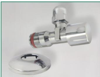
Aus Pressmessing, poliert-verchromt, mit Längenausgleich und Schubrosette, zugfeste Messing-Konus-Quetschverschraubung 3/8" (Ø 10 mm) mit Längenausgleich, Prüfzeichen PA-IX692/IA; Geräuschklasse I, Anschlussgewinde mit Selbstdichtung, Verpackung im Einzelkarton\*
