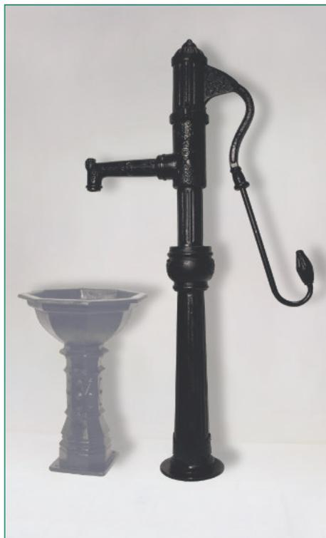
En fonte noir laqué, hauteur d'aspiration 7 meter colonne d'eau, raccordement 1 1/4", piston 75 mm, hauteur totale environ 154 cm
