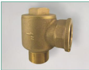
F x M, laiton, version lourde, quille avec joint en caoutchouc, modèle équerre, convient uniquement pour un montage vertical
