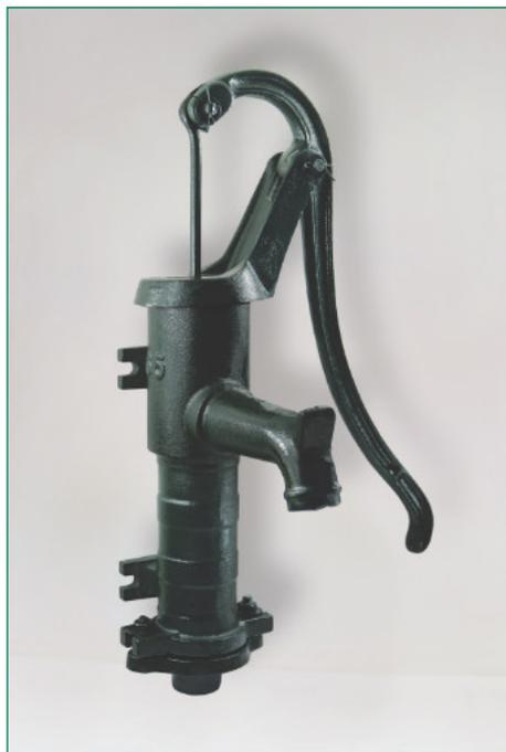
En fonte, vert, pour la fixation à des murs etc., piston 60 mm, hauteur d'aspiration 7 meter colonne d'eau
