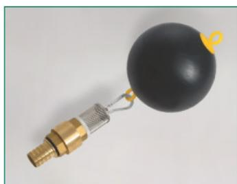
Pour des collectionneurs d'eau actifs/citernes et le semblable, boule de nageur PE noire (Ø 145 mm) avec deux fixations, clapet avec le panier d'acier inox pour dévisser, raccords cannelés 1"
