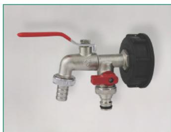
S60 x 6 bouchon femelle, avec joint torique, HDPE-plastique noir, avec robinet à sphère double, matt chromé, raccord de tuyau, poignée en acier rouge, Mini-valve avec connecteur, pas d'usage eau potable
