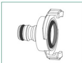
Raccord express avec raccord rapide mâle, non démontable, en laiton brut, dimension universel
