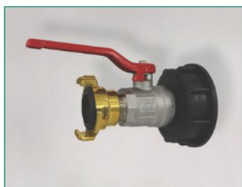
S60 x 6 bouchon femelle, avec joint torique, HDPE-plastique noir, avec robinet à boisseau sphérique, M/M, poignée en acier rouge et raccord rapide en laiton 3/4", largeur de la came 40 mm, pas d'usage eau potable
