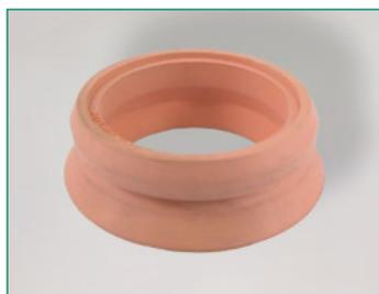
Adéquats à tous raccords express d'une profondeur intérieure de 40 mm. Matière: **NBR, rouge**. Forme des joints conforme au certification KTW-A et W-270. Conformité à l'eau potable.
