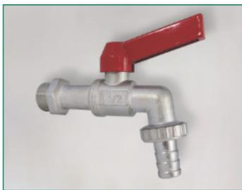
Muni d'une étoile de centrage et raccord au nez en tôle, poignée plat en aluminium non démontable, choix couleur des poignées facultatif rouge ou bleu, Matière: MS 58 laiton matricé, nickelé
