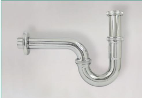
Siphon tubulaire, acier inoxydable, chromé, rosace Ø 65 mm, tube de réglage 75 mm, coude d'évacuation 170 mm
