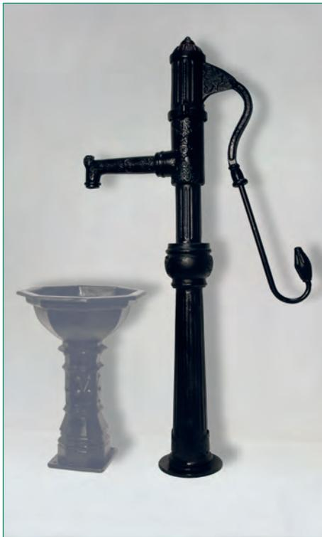
Grauguss schwarz lackiert, Saughöhe 7 Meter WS, Anschluss 1 1/4", Kolben 75 mm, Gesamthöhe ca. 154 cm
