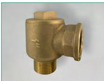
Messing, schwere Ausführung, Schließkegel mit Gummidichtung, IG/AG, Eckform, nur für senkrechten Einbau geeignet
