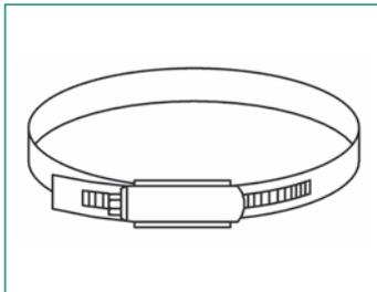
Aus verzinktem Stahl, nach DIN 3017, Bandbreite 9 mm, SW 7 mm
