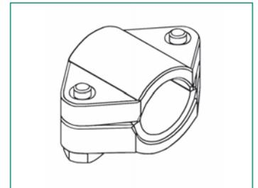
Zamak-Rohrschellen alternativ mit Messingüberzug, 2 stahlverzinkte Klemmschrauben mit Kreuzschlitz und einem Innengewinde M7
