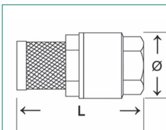
Mit Feder, Ventilkegel aus Kunststoff mit Gummidichtung, Saugkorb aus feinmaschigem Edelstahlgeflecht
