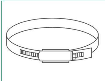
Band und Gehäuse aus Edelstahl oder gleichwertigem korrosionsbeständigem Stahl gemäß DIN 3017, Schraube Stahl verzinkt, Bandbreite 9 mm
