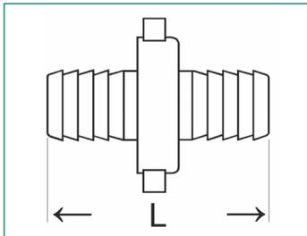
Flachdichtend, inkl. Dichtung aus NBR, warmgepresst
