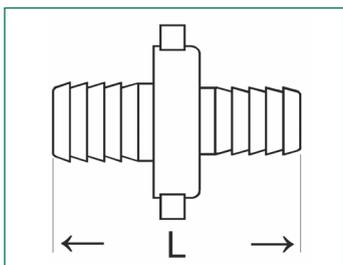
Flachdichtend, inkl. Dichtung aus NBR, warmgepresst
