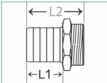
Messing, warmgepresst, blank, für Schelleneinbindung, AG
