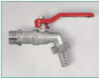
Mit Zentrierstern und Schlauchverschraubung, wahlweise aus Kunststoff oder Blech, lackierter Formstahlhebel, Material: MS 58 warmgepresst, vernickelt
