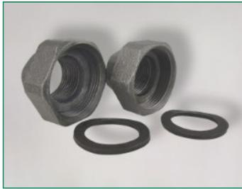
Pumpenverschraubungs-Set, Temperguss, schwarz, bestehend aus 2 Überwurfmutter, 2 Einlegeteilen und 2 Dichtungen aus NBR, Temperaturbereich: < 70°C
