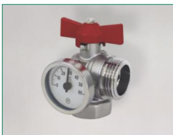
Vernickelt, kurze Bauform, IG x AG, Thermometer Ø 41,5 mm, Thermometeranschluss Ø 15 mm x 9 mm tief, Temperaturbereich 0 - 60°C, Metallgehäuse, SW 37
