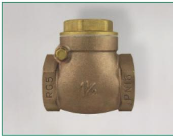
Körper in RG 5, andere Teile in Messing, IG/IG, metallisch dichtend, nur für senkrechten Einbau geeignet
