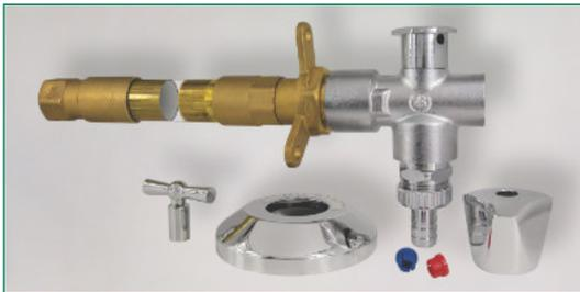
Zur Sicherung gegen Einfrieren der im frostgefährdeten Bereich angebrachten Auslafeinheit, Auslafeinheit matt-verchromt, stufenlos einstellbare Einbautiefe von 240 - 410 mm, komplett mit Befestigungsmaterial
