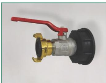
S60 x 6 Grobgewinde (IG) und IG (Anschlussgewinde), mit O-Ring, HDPE-Kunststoff schwarz, mit Kugelhahn, AG/AG, roter Stahlhebel und MS-Schnellkupplung 3/4", Nockenweite 40 mm, Verwendung nur für Brauch-/Nutzwasser
